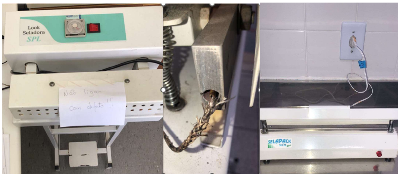
Figura 4. Seladora incapacitada com defeito em destaque ao centro e a esquerda seladora nova.
