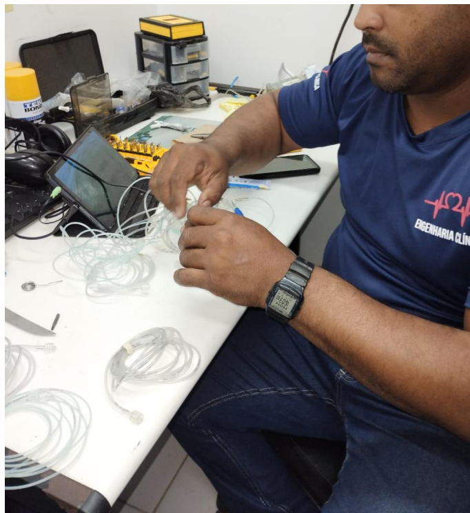
Figura 3. Manutenção dos sensores de capnografia.
