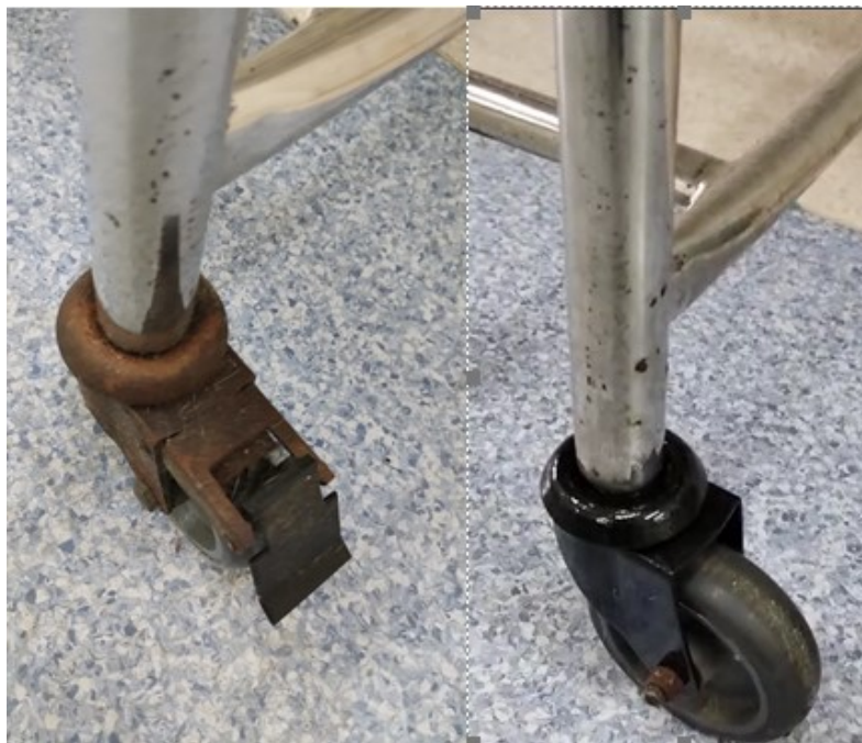
Figura 7. Rodízios antes e após manutenção e pintura.
