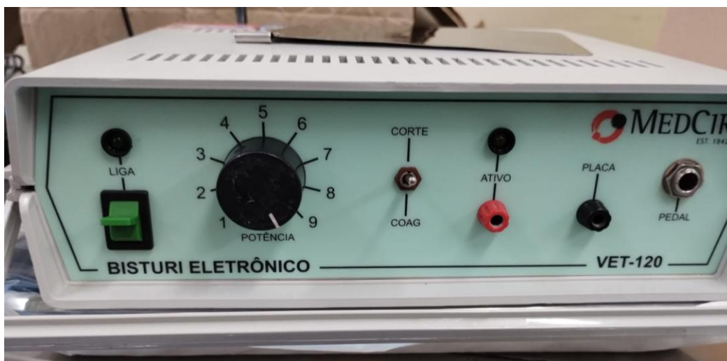
Figura 161. Bisturi eletrônico da marca MEDCIR, entregue ao centro cirúrgico após manutenção corretiva.
