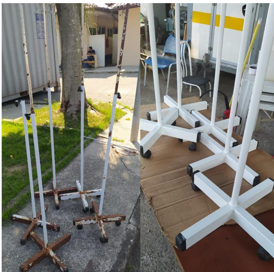
Figura 10. Suportes de frascos de soro, para fluidoterapia, antes e após a manutenção.
