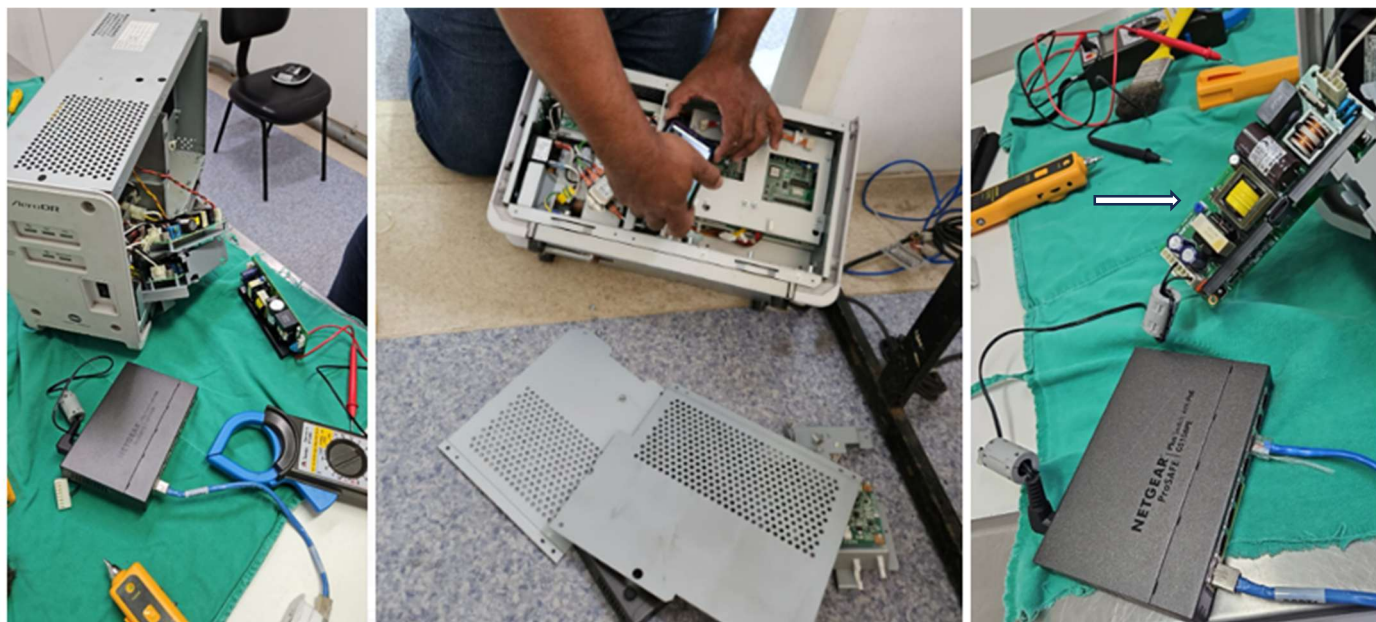
Figura 7. Diagnóstico dde defeito na fonte interna do modem do Aero DR.
