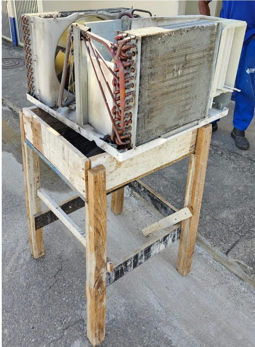
**Figura 7. Limpeza do aparelho de ar-condicionado.**
