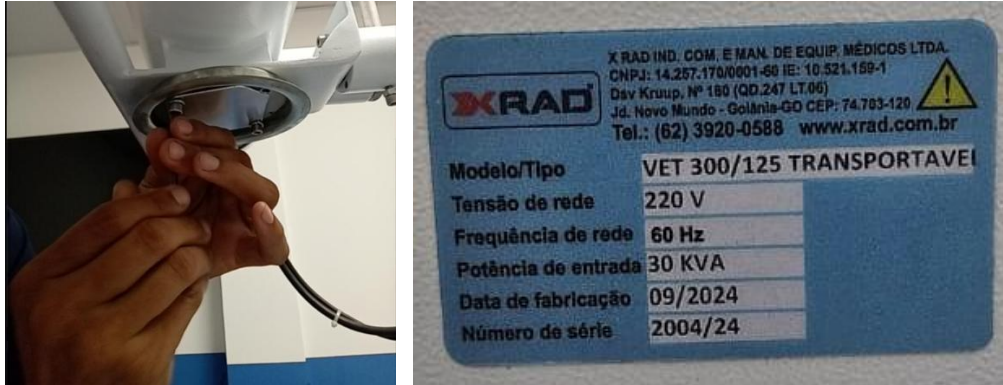
Figuras 07 e 08 – Troca da camada semi-redutora e colocação da placa de identificação do aparelho de radiologia do HMVSFA pela Engenharia Clínica.
